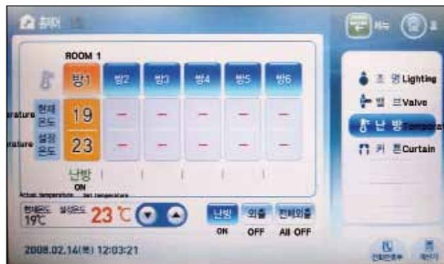
Une utilisation confortable des fonctions KNX par un écran tactile central: par exemple, les menus pour le chauffage, rideaux et l'éclairage.
